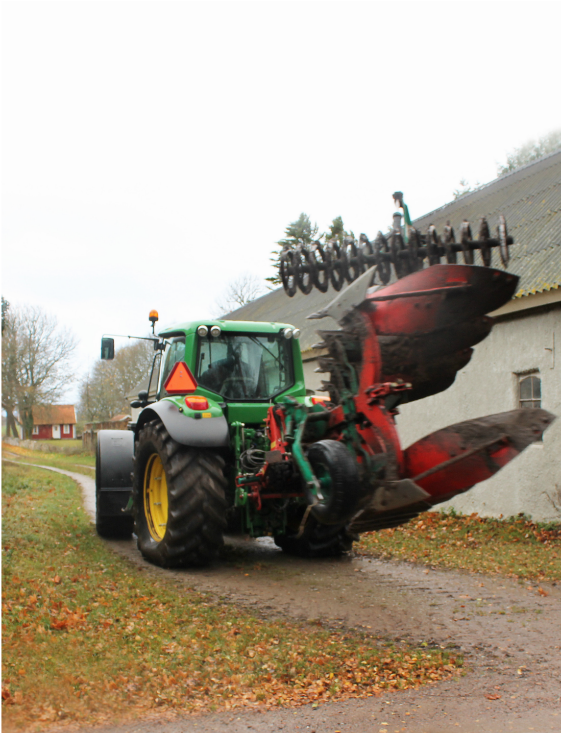
Dagens redskap, här en växelplog med tiltpackare, kan mäta sig med de äldre husen i storlek. Foto: Leo Eriksson
