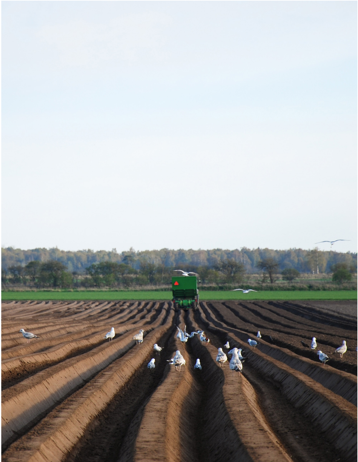
En traktor med en maskin för potatissättning. Maskinen gör fåran, sätter potatisen och formar jorden till ryggar för potatisen att växa i. Foto: Cilla, Mostphotos
